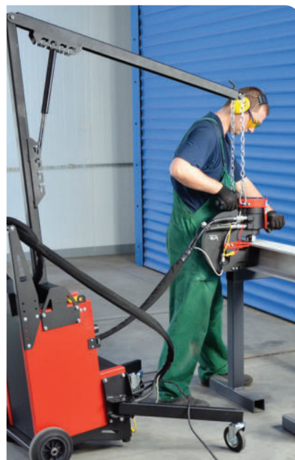
Obesni sistem na kolesih, ki omogočajo enostavno manipulacijo
