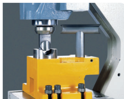
Priprava za izsekovanje cevi
